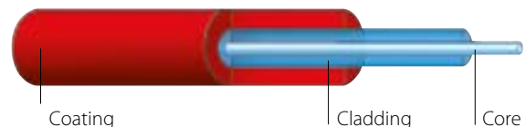
Aufbau einer Singlemode-Faser (E9/125)
