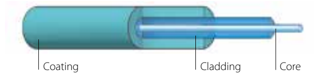
Aufbau einer Multimode-Faser (G50/125)
