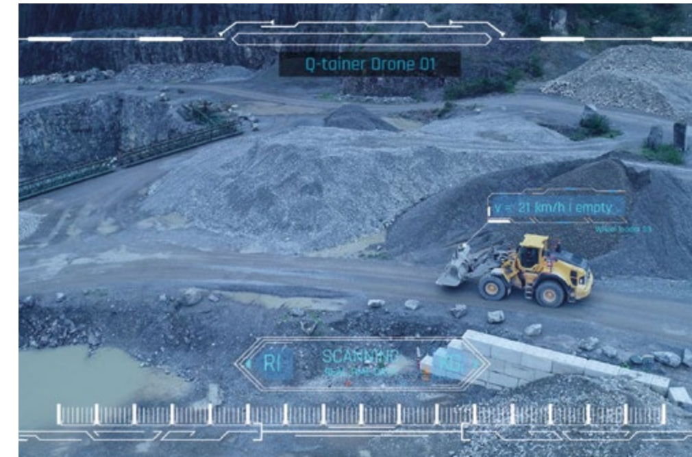
Das System erfasst mit Hilfe von Drohnenaufnahmen unter anderem Bewegungsprofile und Beladungsmengen der Baumaschinen im RCR.
