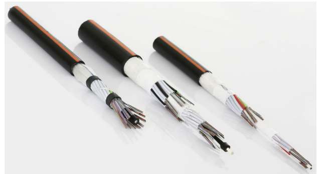
I cavi ottici da esterno "FO Outdoor" di Datwyler sono "virtualmente a tenuta d'acqua laterale", grazie alla combinazione di guaina HDPE, elementi espandibili e riempimento con gel.
