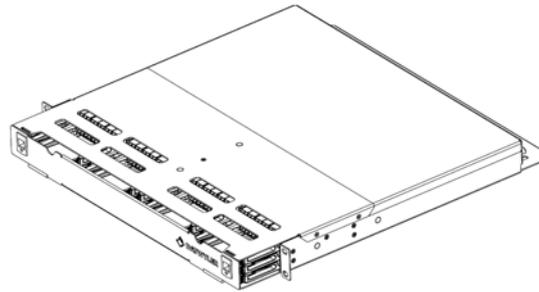
HDPS Patch Solution - HDPS 高密度配线架
