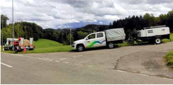
必要支持：带有挂缆小车和空气压缩机的车辆
